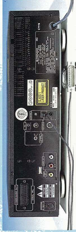
Pioneer CLD 1500 Rückseite mit Steuerinterface in CONTROL IN-Buchse
