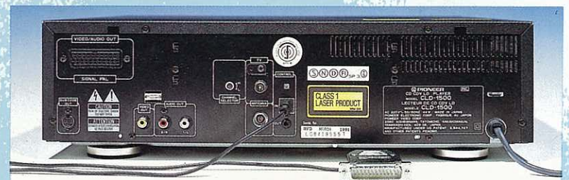
Pioneer CLD 1500 Rückseite mit Steuerinterface in CONTROL IN-Buchse
